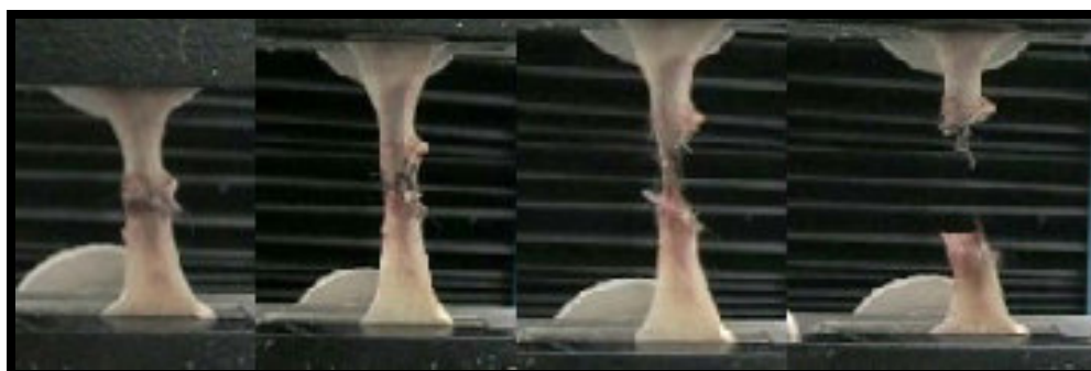
FIGURA 13. SEQUÊNCIA DO ESTUDO TENSIO MÉTRICO MOSTRANDO A RUPTURA DA ANASTOMOSE
