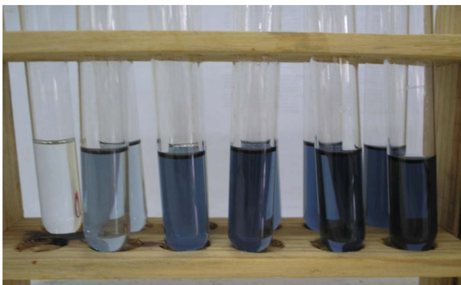
FIGURA 2 – CURVA DE CALIBRAÇÃO PARA DOSAGEM DE FENÓLICOS TOTAIS
