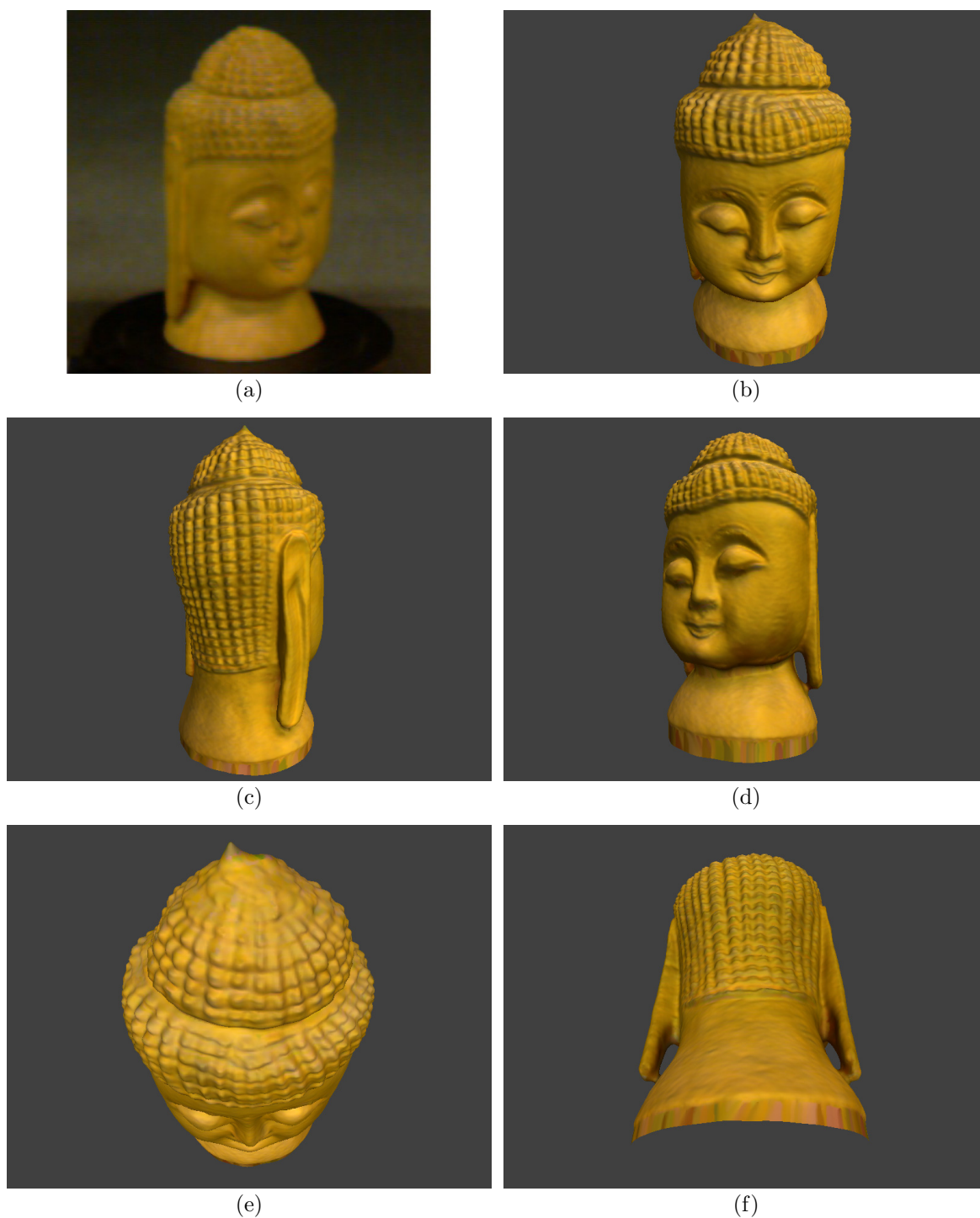
Figura 13.8: Objeto Buddha, do repositório de modelos do laboratório SAMPL da Universidade de Ohio. (a) Imagem colorida original de uma das vistas capturadas; (b) a (f) Renderizações do modelo 3D reconstruído. O modelo possui 445.306 faces, e foi reconstruído com voxels de 0,7mm. A qualidade dos dados deste objeto é muito inferior à qualidade dos outros objetos que foram reconstruídos, pois utilizou-se do scanner Vivid 700 da Konica Minolta. Todos os outros objetos que reconstruímos utilizaram-se do scanner Vivid 910, também da Konica Minolta. Além de possuírem muito mais ruído, as imagens do Vivid 700 possuem uma resolução de apenas 200 \times 200 pixels (o Vivid 910 possui 640 \times 480 pixels ). Este objeto foi capturado utilizando-se apenas uma turntable , logo é impossível reconstruir corretamente o topo e a base da estátua.
