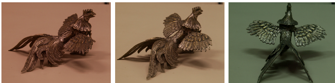
Figura 3.5: Erros de cor nas imagens do scanner 3D Vivid 910 . A imagem central é a que possui as cores mais próximas das reais.
