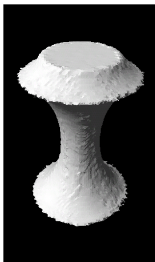
Figura 6.18: Resultado do algoritmo de integração de Sagawa [124]. As bordas reconstruídas são de baixa qualidade, e a superfície não é suave.
