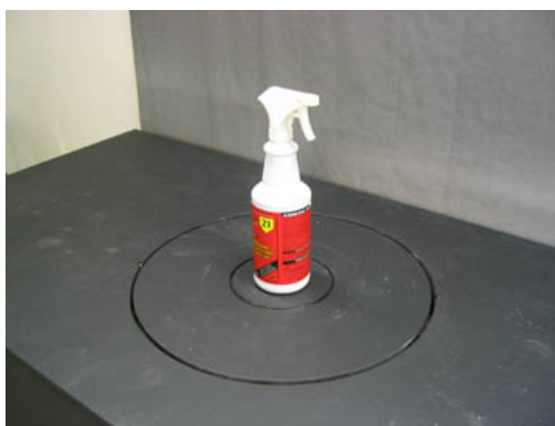
Figura 4.2: Turntable utilizada para o pré-alinhamento de vistas. Consiste em uma plataforma giratória, de forma que o ângulo de rotação entre cada vista possa ser pré-determinado. 1
