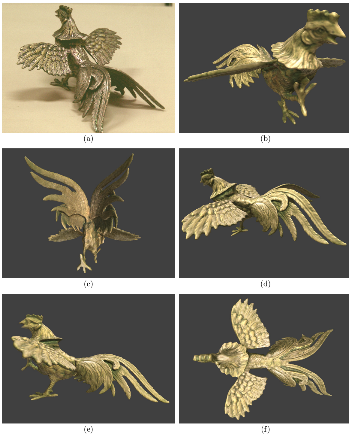
Figura 13.9: Estátua em latão de um galo, do acervo pessoal de Alexandre Vrubel. (a) Imagem colorida original de uma das vistas capturadas; (b) a (f) Renderizações do modelo 3D reconstruído. O modelo possui 593.584 faces, e foi reconstruído com voxels de 0,5mm. Apesar de ser um material não cooperativo opticamente (devido ao alto grau de especularidade), a reconstrução geométrica não apresentou problemas. As cores das imagens individuais foram manualmente corrigidas, pois estavam muito erradas (vide figura 3.5).
