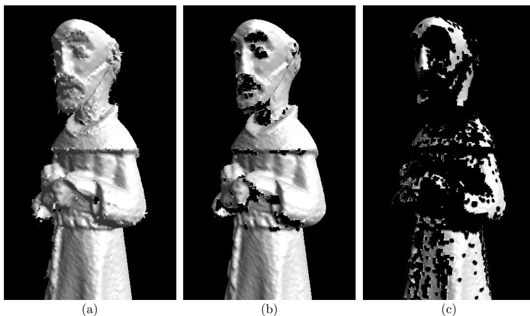
Figura 6.13: Objeto reconstruído pelo algoritmo de Wheeler com vários limiares de consenso, descartando medidas para bordas de vistas. (a) \theta = 0.0 ; (b) \theta = 2.0 ; (c) \theta = 5.0 . Apenas medidas em consenso foram utilizadas nas reconstruções.
