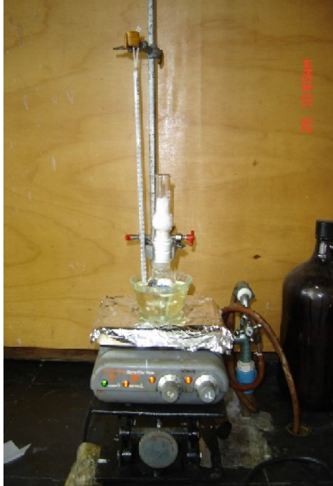
Figura 20 – Ilustração da aparelhagem utilizada para a reação de obtenção do pré-polímero dos poliuretanos sintetizados
