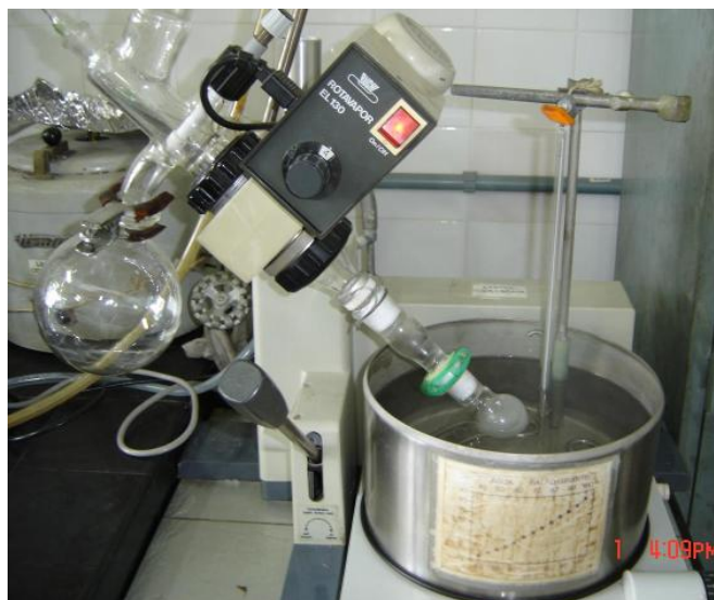
Figura 21 – Evaporador rotatório utilizado para a segunda etapa da reação de obtenção do poliuretano
