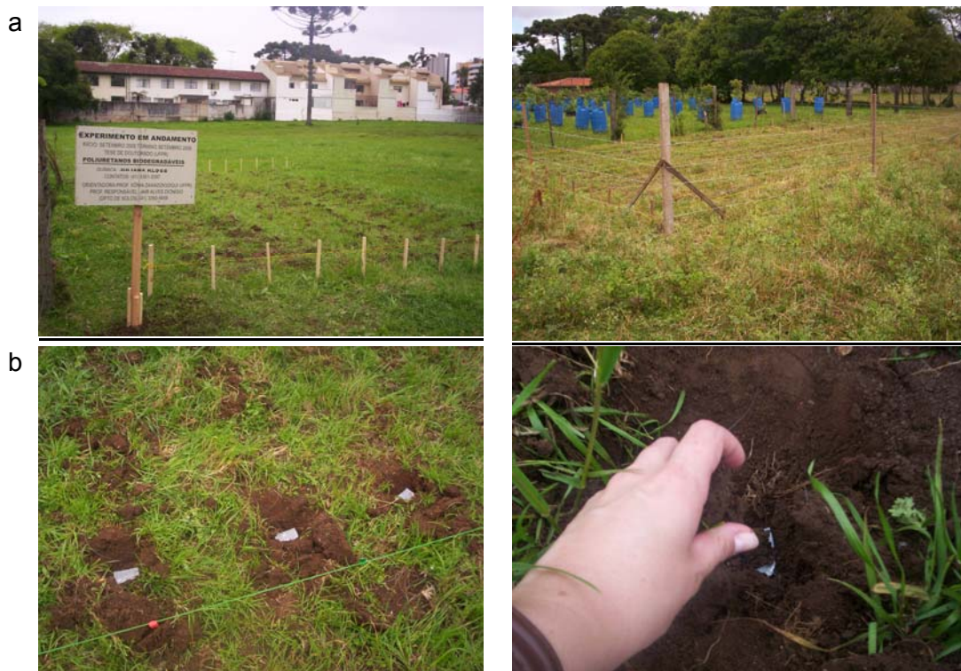
Figura 25 – Análise de biodegradação de poliuretanos e de poli( \epsilon -caprolactona)diol no solo
