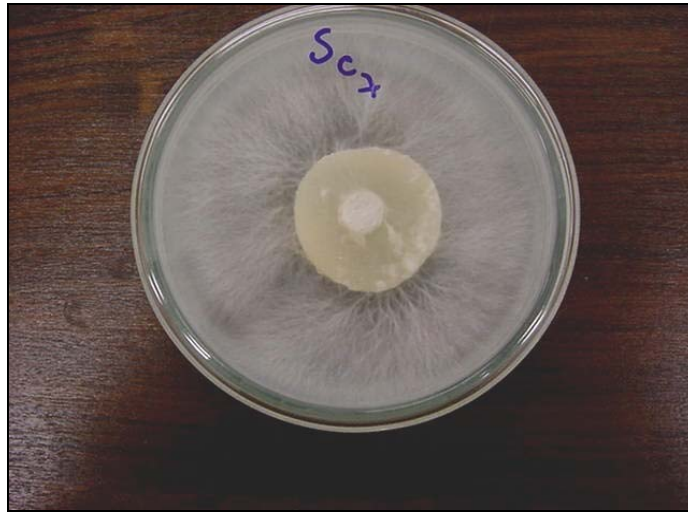
Figura 22 – Ilustração do ensaio de biodegradação com o fungo Pleurotus sajor-caju em fase sólida
