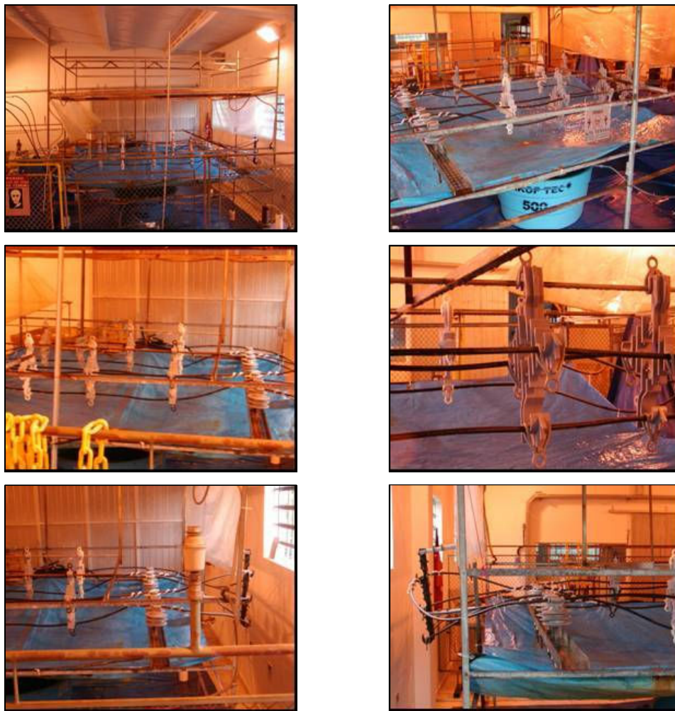
Figura 23 - Arranjo experimental onde são realizados os ensaios de multiestressamento
