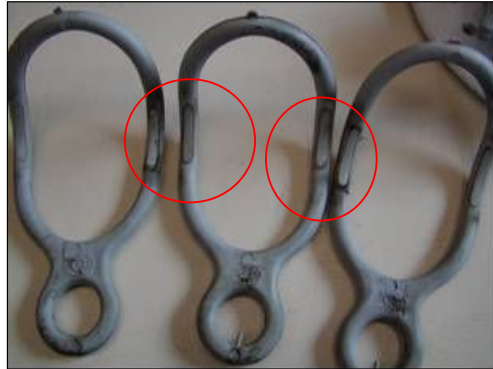
Figura 32 - Anéis de amarração do fabricante b com elevada deformação permanente e trilhamento elétrico, após 40 dias
