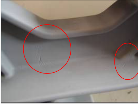
Figura 36 - Detalhe das alterações superficiais ocorridas no espaçador do fabricante c devido a passagem de corrente de fuga no material durante o ensaio de multiestressamento, após 40 dias
