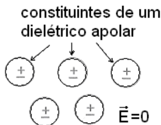
Figura 6 - Constituintes apolares de um dielétrico sem momentos de dipolo intrínsecos
