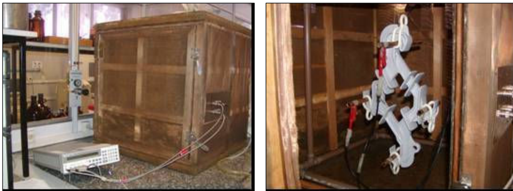
Figura 24 - Arranjo experimental utilizado para as medidas de resistência de isolamento em espaçadores
