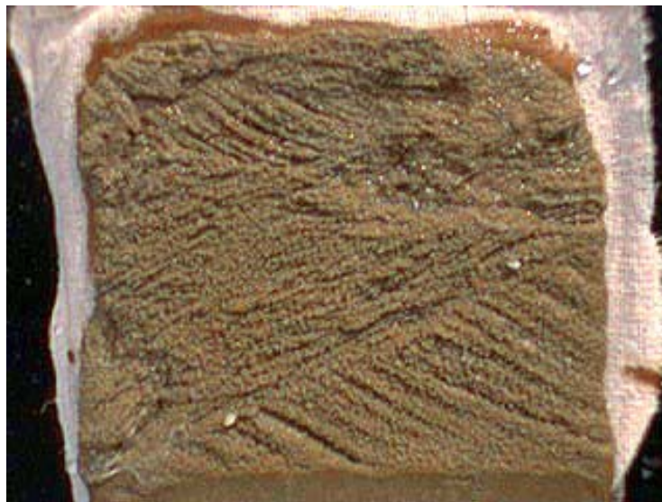
Figura 33 - Peeling após lavagem em água corrente. Observar que a imagem obtida é o espelho da original.
