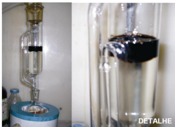
FIGURA 17 – APARELHO DE SOXHLET ADAPTADO PARA PARTIÇÃO LÍQUIDO-LÍQUIDO
