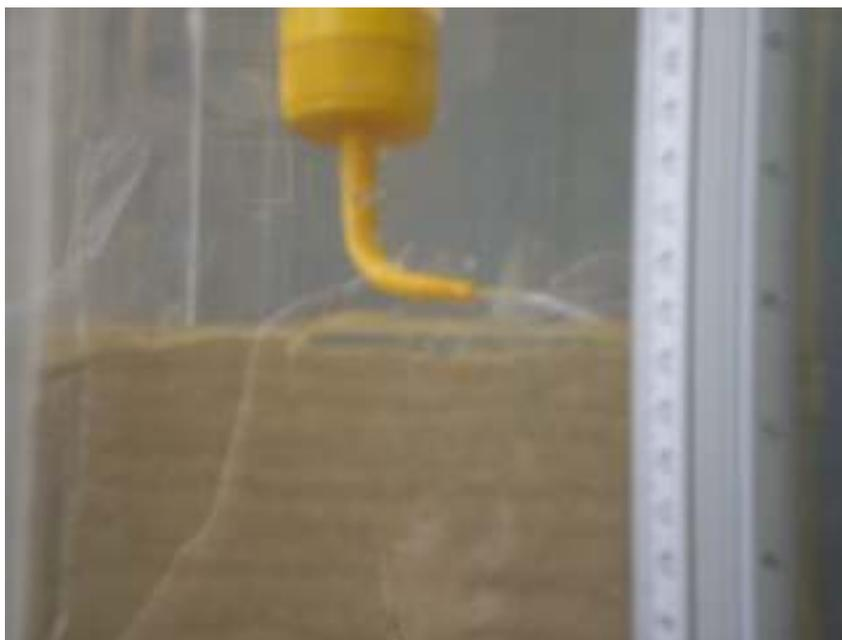
FIGURA 4.18 – COLOCAÇÃO DE ÁGUA SOBRE O MATERIAL TRATADO
