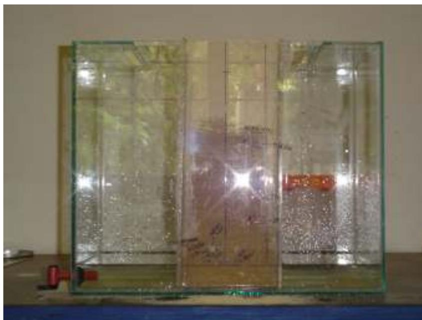
FIGURA 4.10 – ENSAIO DE UMEDECIMENTO PARA MATERIAL NATURAL
