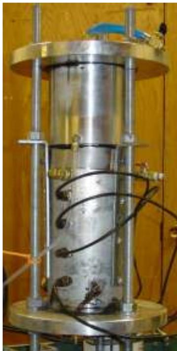
FIGURA 2.8 - PERMEÂMETRO TIPO EDA PARA FLUXO PERMANENTE
