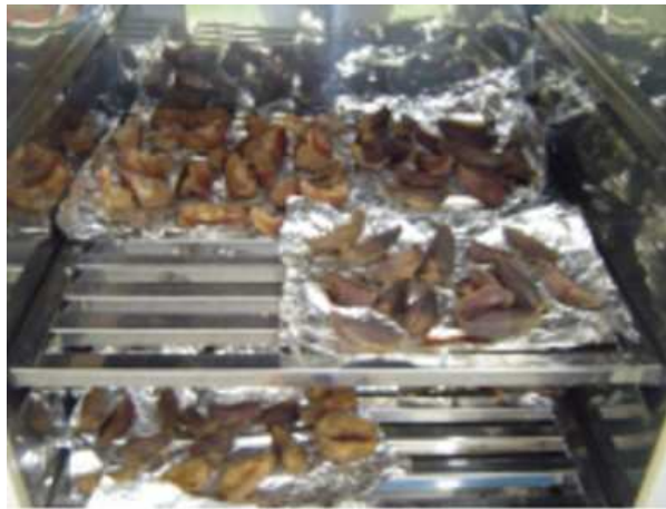
FIGURA 17 – ESTUFA ELÉTRICA COM PEQUENA ABERTURA NA PARTE SUPERIOR PARA A SAÍDA DE AR NA EXTRAÇÃO DE MATÉRIA SECA DE TUBÉRCULOS DE BATATA.
