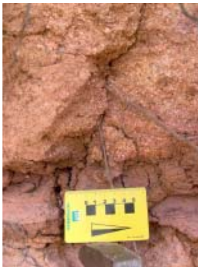
Figura 4.11 - Formação Guabirota com camada de 40 cm de areia grossa sobre siltito com espessura de 10 cm. Rua Antonio Buso, em frente à estação da COPEL, bairro Cajuru, coordenadas UTM: W680217, S7181325.
