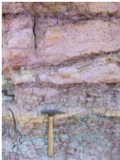
Figura 4.13 - Formação Guabirota com lentes de areia grossa intercaladas por silte pastilhado. Rua Antonio Buso, em frente à estação da COPEL, bairro Cajuru, coordenadas UTM: W680217, S7181325.
