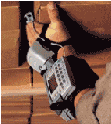
FIGURA 2.14 – TERMINAL DE RÁDIO FREQUÊNCIA COM LEITURA ÓTICA
