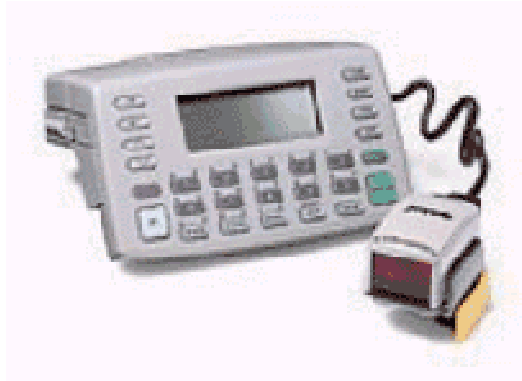
FIGURA 2.14 – TERMINAL DE RÁDIO FREQUÊNCIA COM LEITURA ÓTICA
