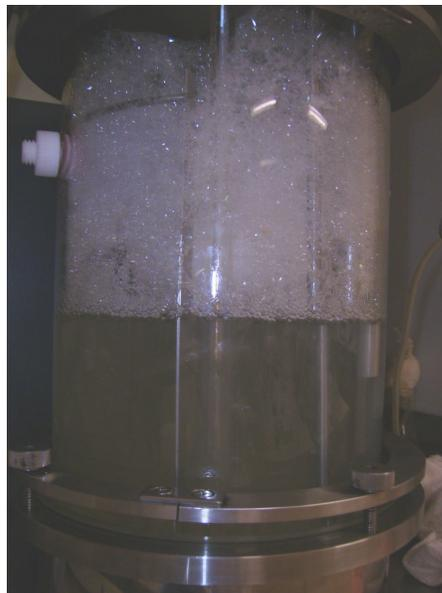
**Figura 6.** Cultivo de *Pseudomonas aeruginosa* UFPEDA 614 por fermentação submersa em biorreator (Bioflo-III Fermentor – New Brunswick Scientific), mostrando a grande formação de espumas com menos de 10 h de fermentação. Meio e condições de cultivo ver Figura 5.
