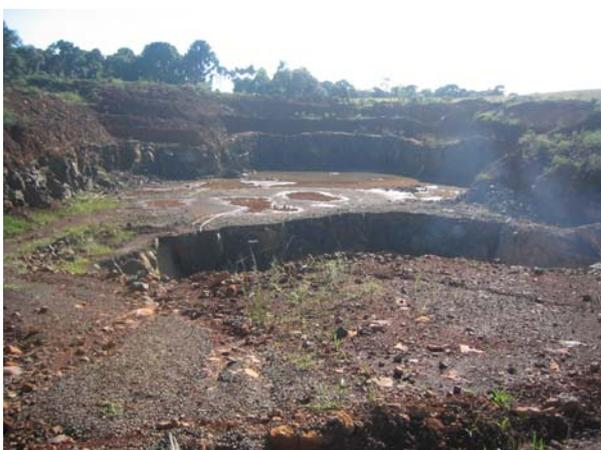
Foto 7: Antiga frente da pedreira de basalto com bancadas. Ponto A4
