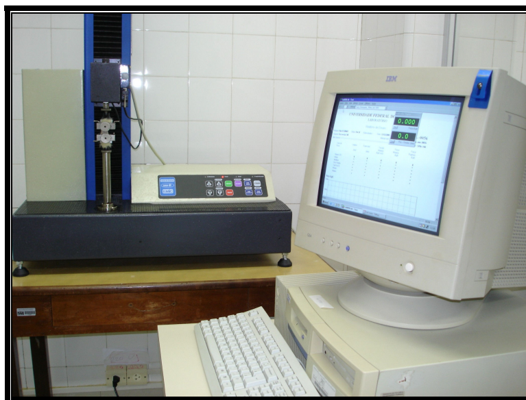
FIGURA 2 – APARELHO DE TRAÇÃO DL500MF – EMIC ® , UTILIZADO PARA OS TESTES TENSOMÉTRICOS DE RESISTÊNCIA TECIDUAL DAS FERIDAS INCISIONAIS.
