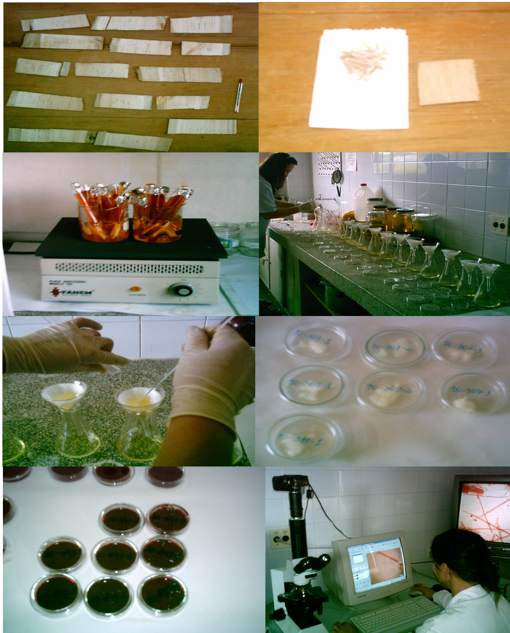
FIGURA 10 - SEQÜÊNCIA DA PREPARAÇÃO DE AMOSTRAS PARA AS MEDIÇÕES DAS FIBRAS
