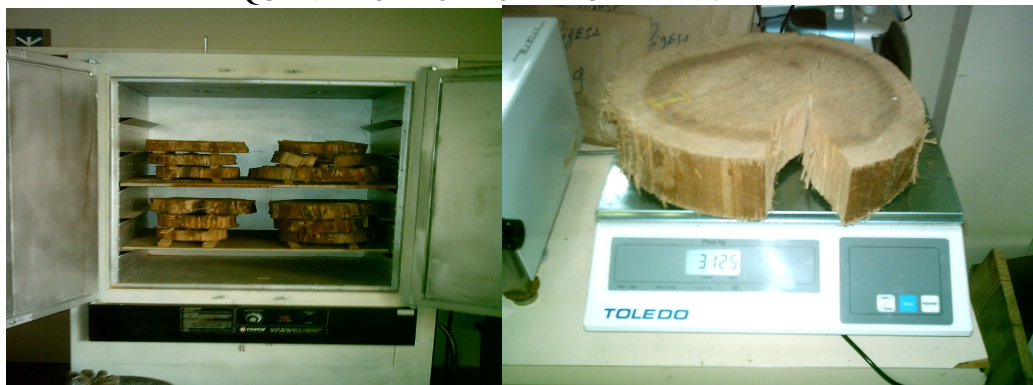
FIGURA 09 - SECAGEM EM ESTUFAS E PESAGEM DOS DISCOS PARA QUANTIFICAR O TEOR DE UMIDADE.
