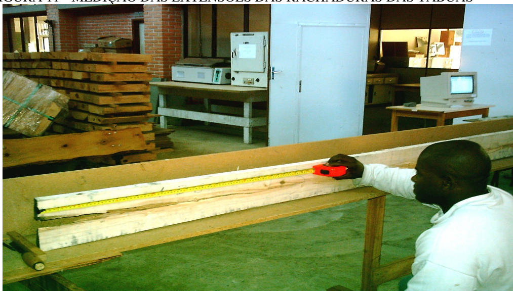
FIGURA 11 - MEDIÇÃO DAS EXTENSÕES DAS RACHADURAS DAS TÁBUAS
