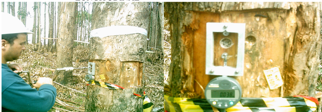
FIGURA 04 - APARELHO E COLETA DAS DEFORMAÇÕES RESIDUAIS LONGITUDINAL
