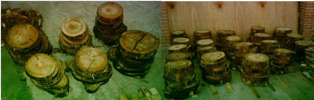
FIGURA 08 – SECAGEM AO AR LIVRE DOS DISCOS PARA MEDIÇÃO DO TEOR DE UMIDADE E ANATOMIA DA MADEIRA
