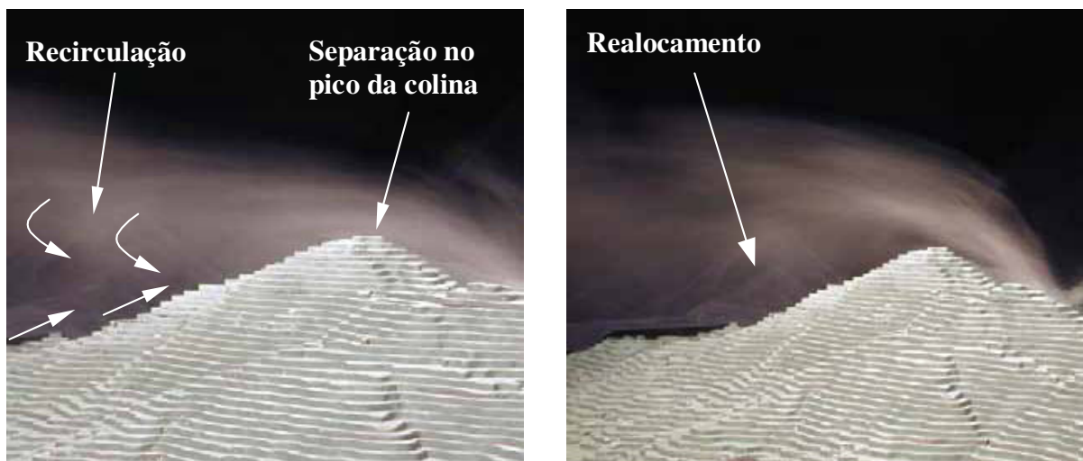
Figura 1.1: Visualização com fumaça do escoamento em túnel de vento (Dericksen et al., 2004)
