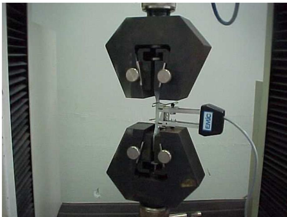
Figura 3.6 - Detalhe do extensômetro utilizado no ensaio de tração
