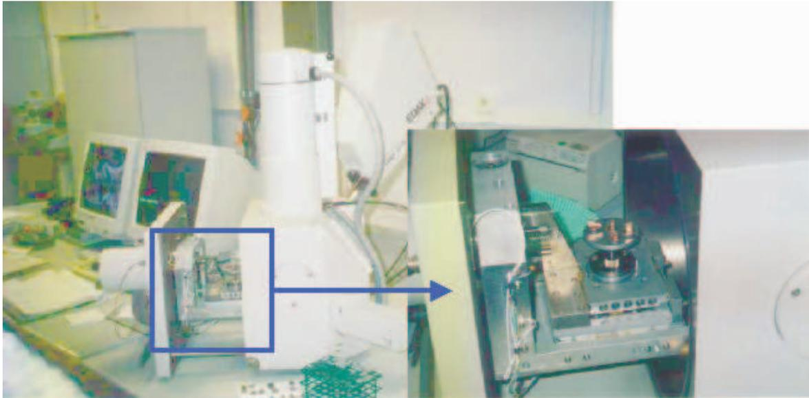
Figura 3.8- Foto do equipamento de microscopia eletrônica de varredura
