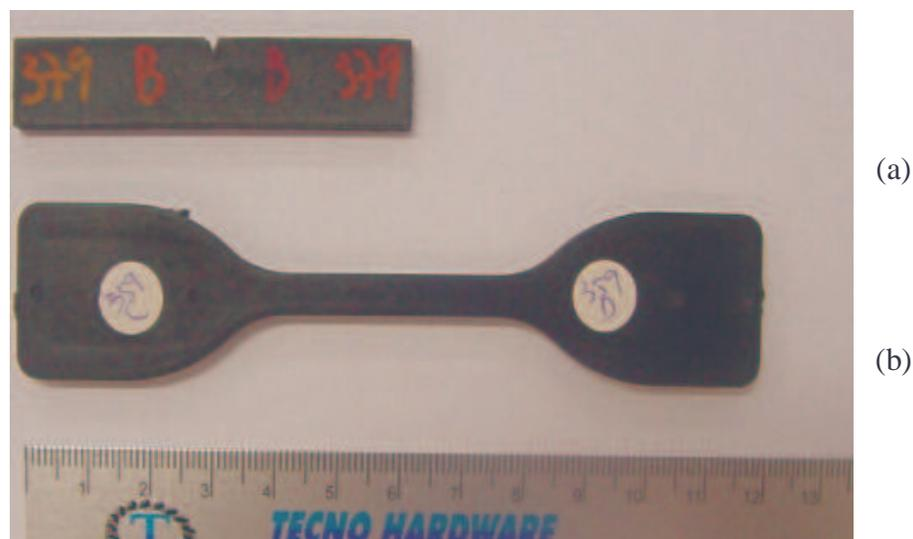
Figura 3.4 – Foto do corpo de prova utilizado para ensaio de impacto (a) e tração (b)
