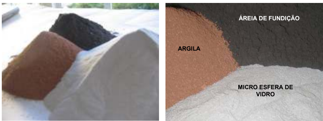
Figura 5.4 - Componentes do experimento: areia de fundição, micro esfera de vidro e argila Taguá
