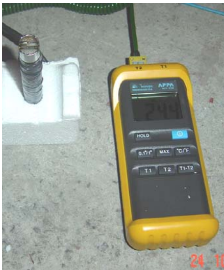
Ilustração 29 – Termômetro digital usado como apoio nas leituras complementares.
