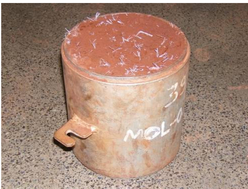
Figura 4.10 - Cilindro de compactação Proctor Normal
