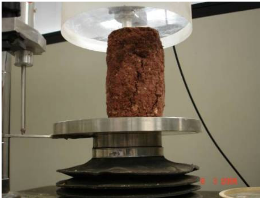
Figura 3.2 – Corpo de prova submetido ao ensaio de compressão simples
