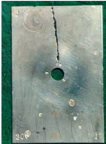
FIGURA 4 - EXEMPLO DE CORROSÃO POR FRESTA EM UM AÇO INOXIDÁVEL. [ABRACO, 2007]
