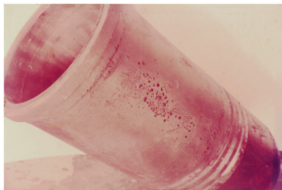
FIGURA 8 - CAVITAÇÃO EM CAMISA DE CILINDRO DE MOTOR DIESEL [GENTIL, 2003].
