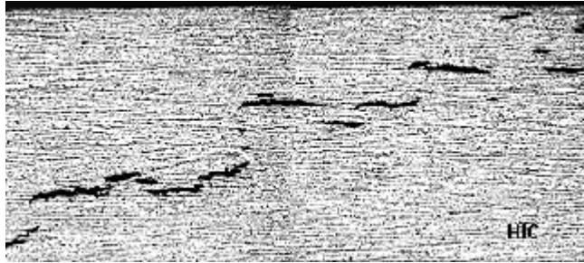
FIGURA 15 - TRINCA INDUZIDA POR HIDROGÊNIO EM ESTRUTURA METÁLICA
