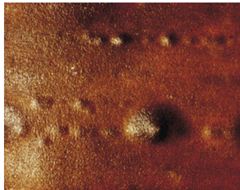
FIGURA 14 - BOLHAS SUPERFICIAIS NA SUPERFÍCIE DE UM AÇO-CARBONO CAUSADA POR EMPOLAMENTO [GENTIL, 2003]
