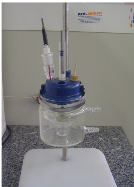
FIGURA 24 - FOTO DA CÉLULA ELETROQUÍMICA COM UTILIZADA NOS EXPERIMENTOS
