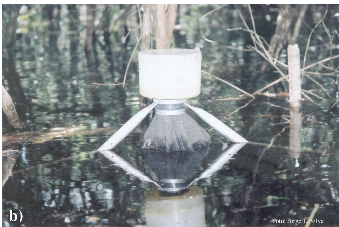
Figura 9. Fotoecletor de solo (a) na superfície do solo em cambarazal no Pantanal de Poconé, Mato Grosso, para avaliação da densidade de emergência da fauna edáfica e (b) armadilhas durante o período de inundação (fevereiro de 2004), evidenciando o nível d'água na floresta.
