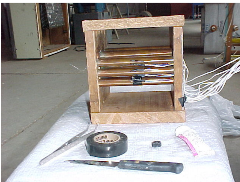
Figura 26 - Vista final da instalação dos termistores
