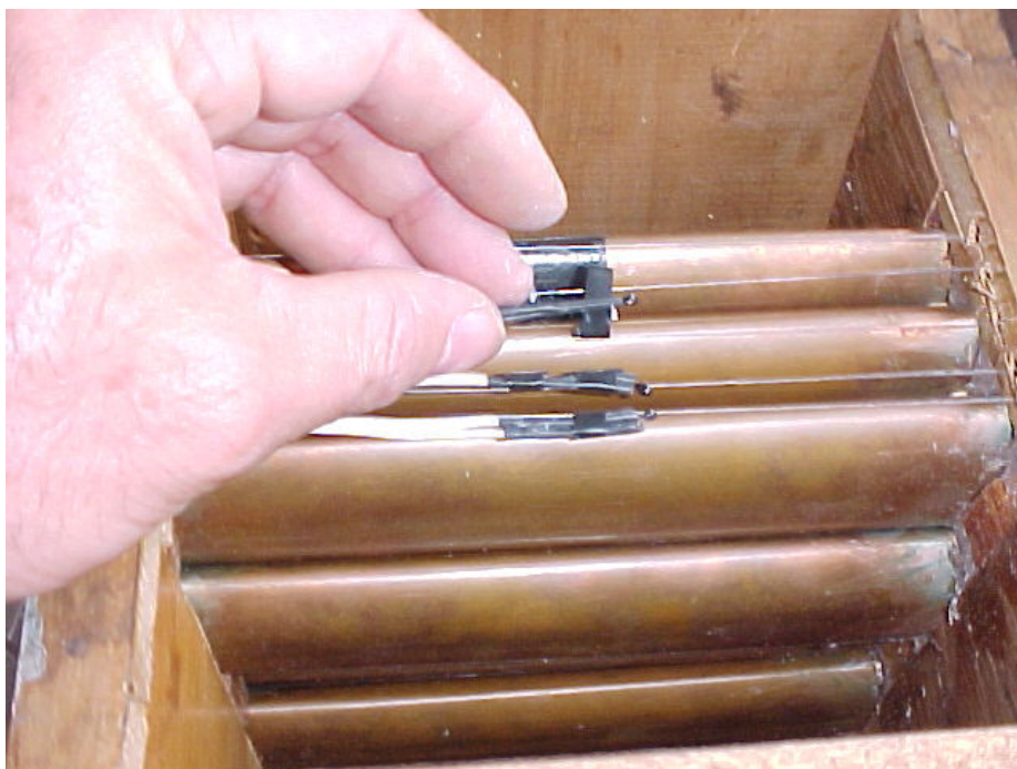
Figura 25 - Instalação dos termistores na entrada do arranjo
