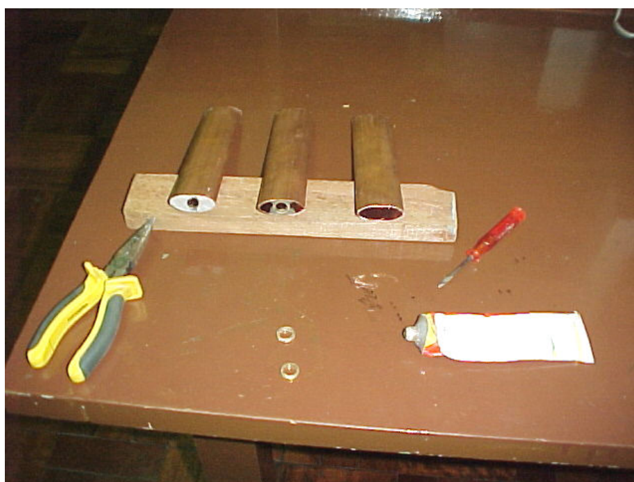
Figura 17 - Montagem dos anéis no interior dos tubos elípticos
