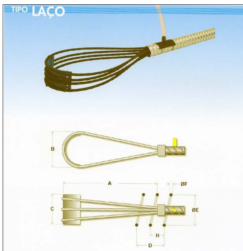
FIGURA 2.15: ANCORAGEM PASSIVA FONTE: Catálogo Técnico da PROTENDE, 2005
