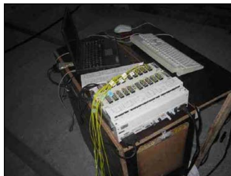
FOTO 3.40: LIGAÇÃO DOS EXTENSÔMETROS
