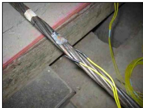
FOTO 3.38: COLAGEM DE EXTENSÔMETROS
