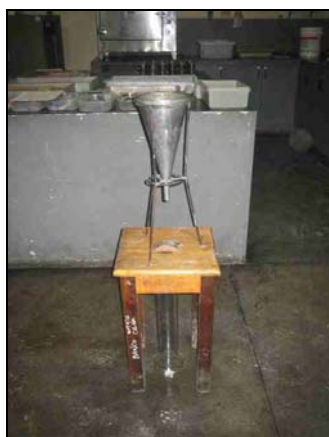
FOTO 3.5: ENSAIO DE CALDA
