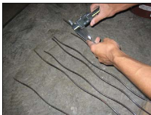
FOTO 4.2: MEDIÇÃO DO DIÂMETRO DOS FIOS DE UMA CORDOALHA
