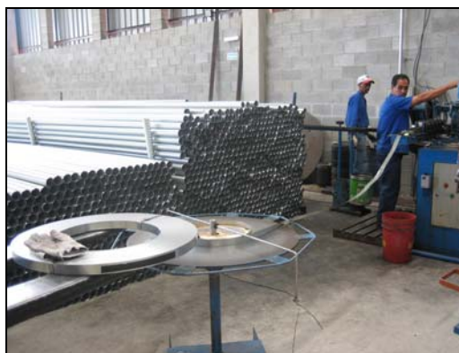
FOTO 2.7: FABRICAÇÃO DE BAINHAS FONTE: Fábrica da PROTENDE, 2006
