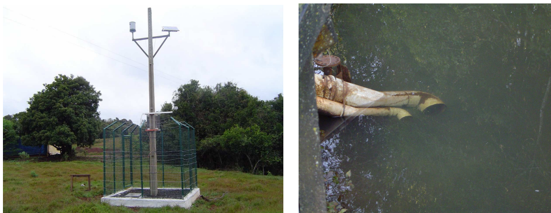
Figura 23 – Foto da estação automática do rio Conrado, foto dos sensores da sonda Hydrolab® e do posicionamento da sonda no canal do rio Conrado.
