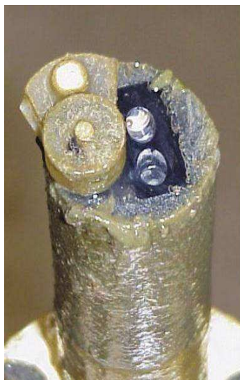
Figura 103 – Sensor de turbidez, quando em período de manutenção e calibração, coberto com material argiloso.
