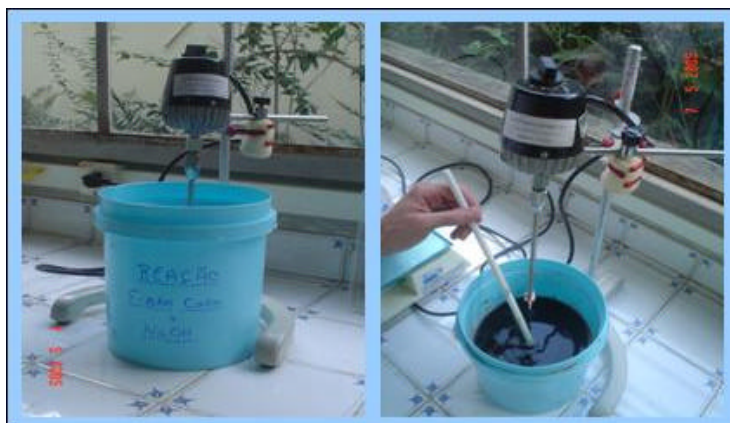
FIGURA 8: Tratamento das fibras com solução de hidróxido de sódio (NaOH)
