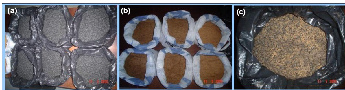
FIGURA 9: (a) Polipropileno antes da mistura; (b) Fibras de coco antes da mistura; (c) Polipropileno e fibras de coco misturados.
