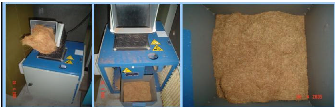
FIGURA 7: Processo de moagem das fibras de coco.
