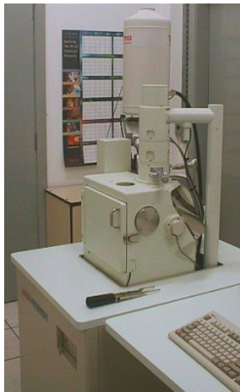
FIGURA 9 - MICROSCÓPIO ELETRÔNICO DE VARREDURA E MICROANÁLISE, 6460 LV, JEOL, DO CENTRO DE MICROSCOPIA ELETRÔNICA DA UNIVERSIDADE FEDERAL DO PARANÁ
