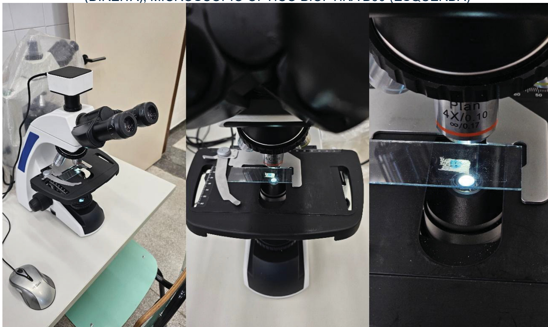
FIGURA 15 - ANÁLISE MICROSCÓPICA DA PENETRAÇÃO DO CORANTE NAS ESPUMAS (DIREITA), MICROSCÓPIO ÓPTICO BIOPTIKA B60 (ESQUERDA)
