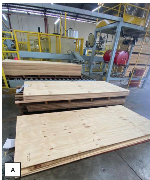
FIGURA 15 - PAINÉIS APÓS PROCESSO DE ESQUADREJAMENTO E LIXAMENTO
