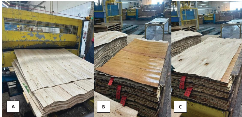
FIGURA 13 - MONTAGEM DOS PAINÉIS COMPENSADOS
