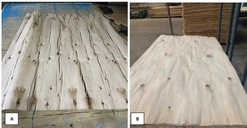
FIGURA 7 – QUALIDADE SUPERFICIAL DAS LÂMINAS APÓS A SECAGEM
