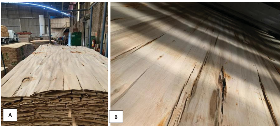
FIGURA 5 – QUALIDADE SUPERFICIAL DAS LÂMINAS COM E SEM PROCESSO DE AQUECIMENTO
