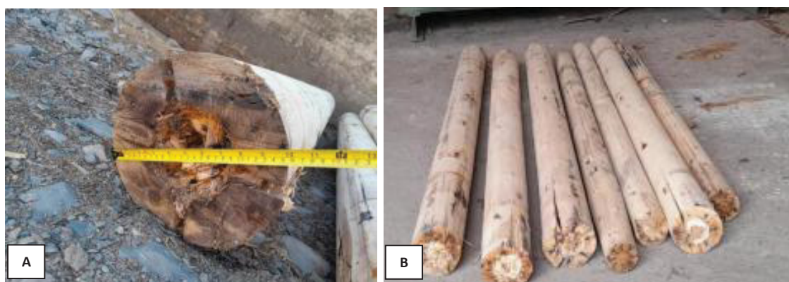
FIGURA 6 - TORAS INUTILIZADAS NO PROCESSO DE LAMINAÇÃO.
