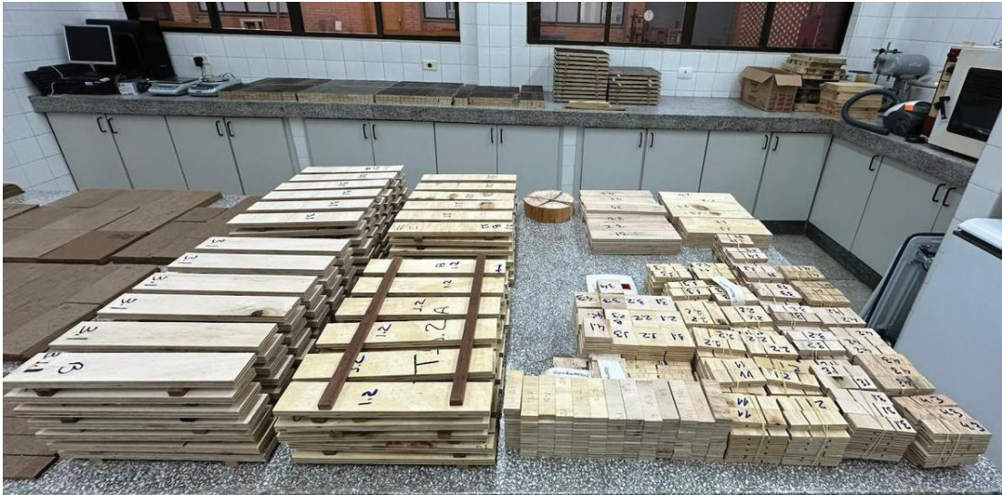
FIGURA 17 - CORPOS DE PROVA CORTADOS PARA OS ENSAIOS
