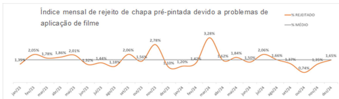
FIGURA 4: Gráfico de valores relativos de rejeição de material CPP devido defeitos durante aplicação de filme
