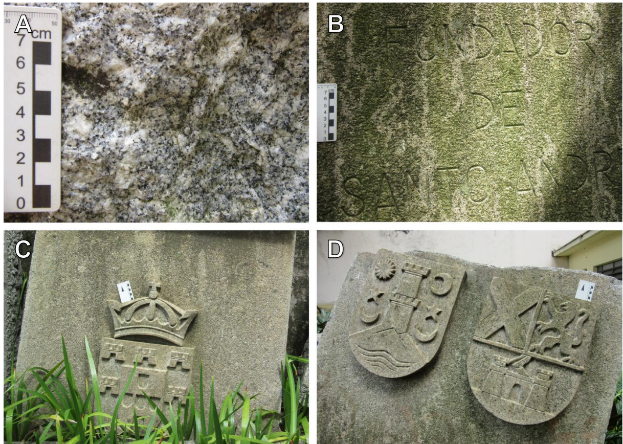
FIGURA 20 – a) Detalhe do Granito Cinza Mauá da antiga base da estátua de João Ramalho; b) Dizeres entalhados e superfície coberta por musgo; c, d) Brasões esculpidos em granito.
