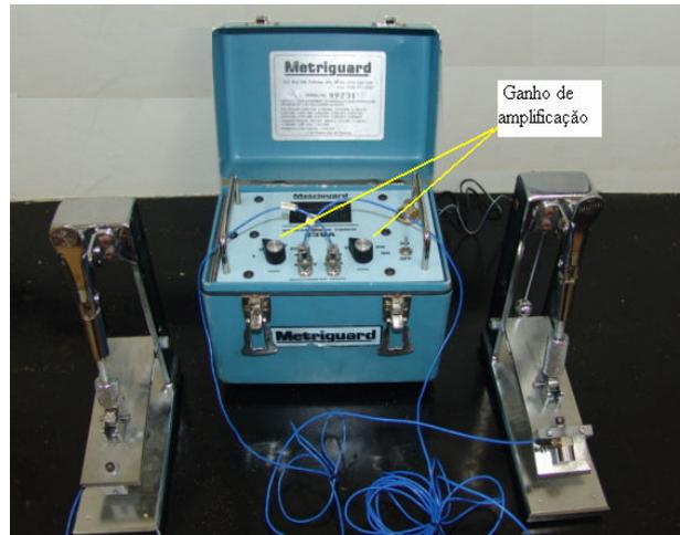
FIGURA 7 – ACIONAMENTO MANUAL DO PÊNDBULO QUE INDUZ A FORMAÇÃO DA ONDA DE TENSÃO APLICADA NAS TÁBUAS DE *Eucalyptus*.
