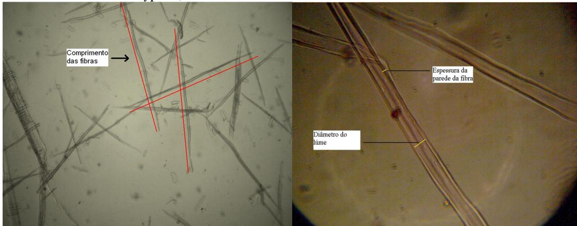
FIGURA 11 – IMAGEM CAPTURADA PELO PROGRAMA WIN CELL E UTILIZADA NA DETERMINAÇÃO DA FREQUÊNCIA DE VASOS/MM<sup>2</sup> E DIÂMETRO MÉDIO DOS POROS DA MADEIRA DE *Eucalyptus*.
