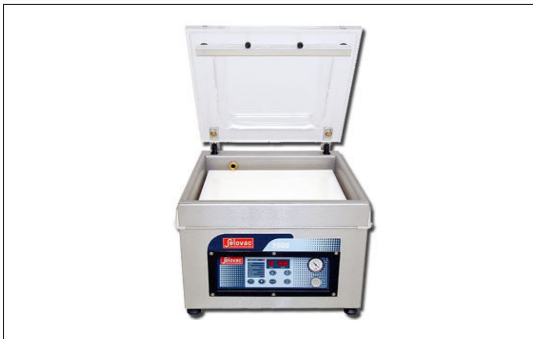
FIGURA 1 – Equipamento marca SELOVAC 200 B, que retira o ar, injeta dióxido de carbono e sela as embalagens, Curitiba – PR, 2004.
