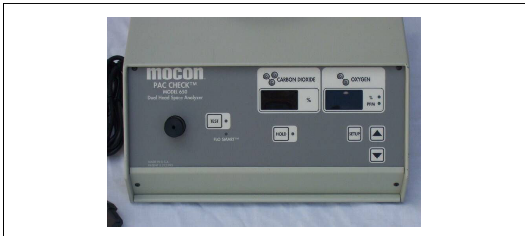
FIGURA 2 – Aparelho analisador atmosférico utilizado para mensurar a concentração de oxigênio e dióxido de carbono no interior das embalagens, Curitiba – PR, 2004.
