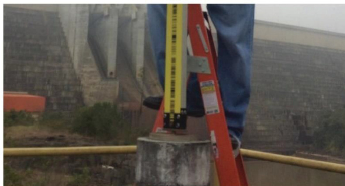
Figura 5 – Nivelamento geométrico no pilar de centragem forçada. Fonte: Autores (2024).
