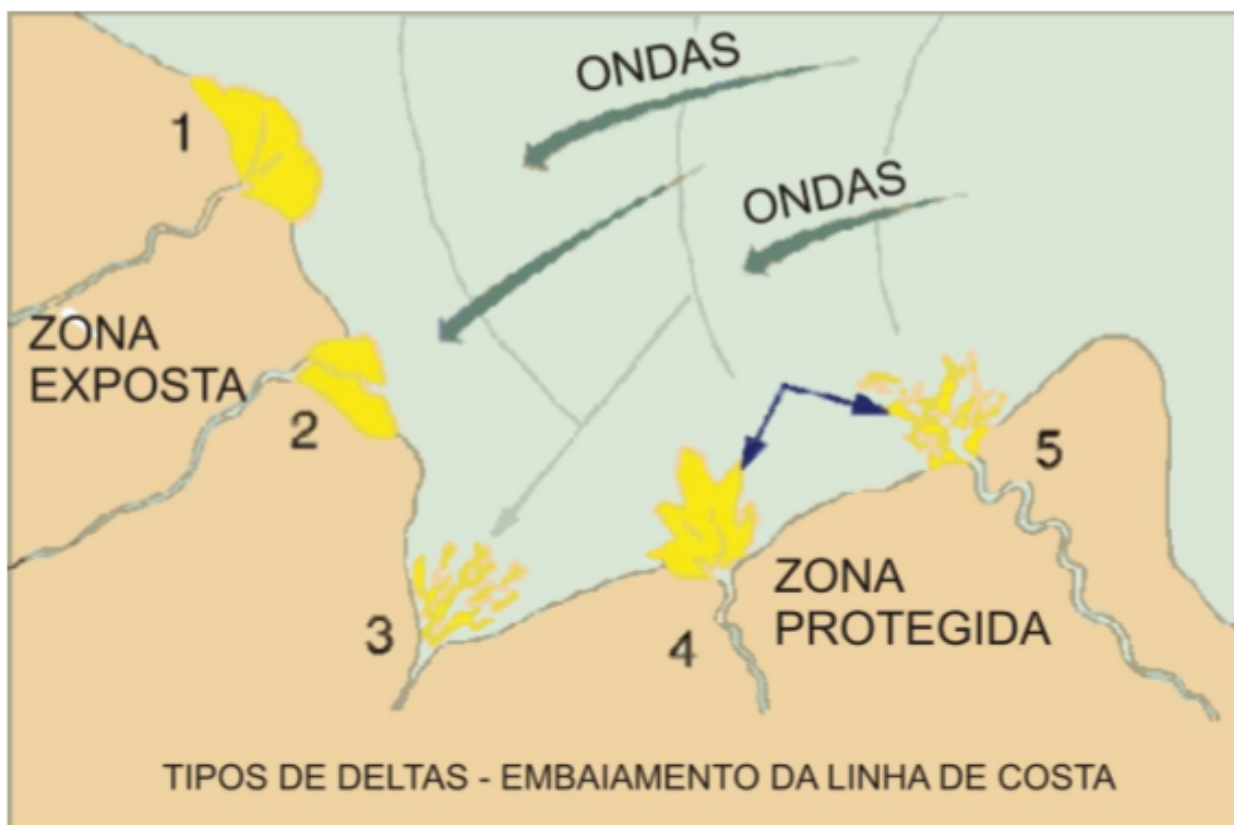
Figura 3.3 - Figura mostrando os tipos de delta. Os deltas 1 e 2 são deltas dominados por ondas, que incidem sobre o sedimento deltaico derivado do rio. O delta 3 é um delta dominado por maré e os deltas 4 e 5 são deltas dominados pelo rio. Retirado e modificado de Slatt (2006).
