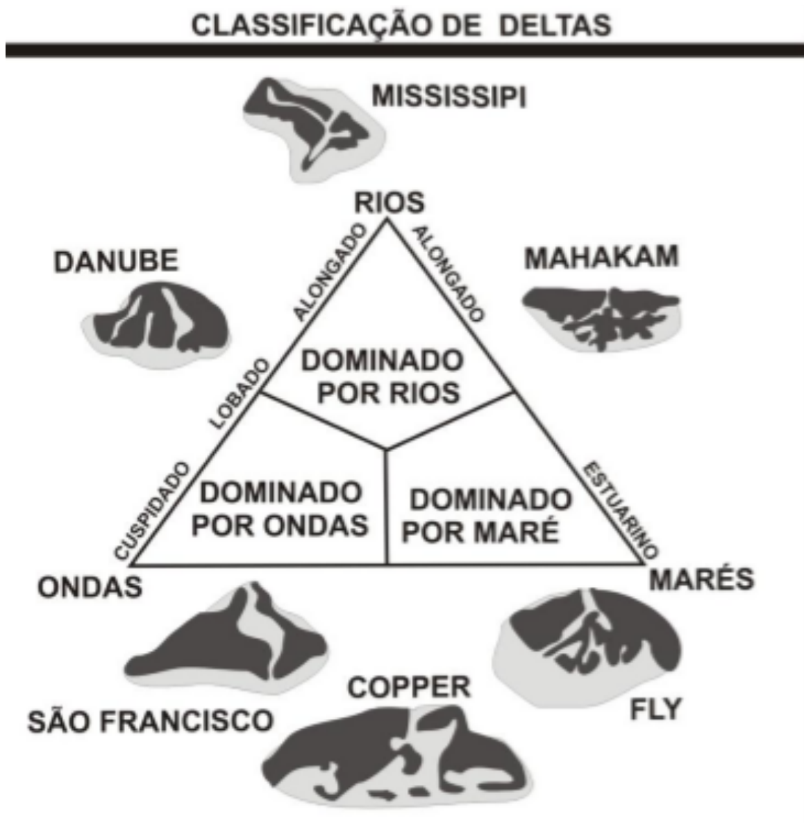
Figura 3.2 - Figura mostrando a classificação genética de deltas, baseada segundo três membros extremos, rios, ondas e marés: Deltas dominados por rios, deltas dominados por ondas e deltas dominados por marés, estabelecido por Galloway (1975). Modificado de Galloway (1975, in Soares 2009).
