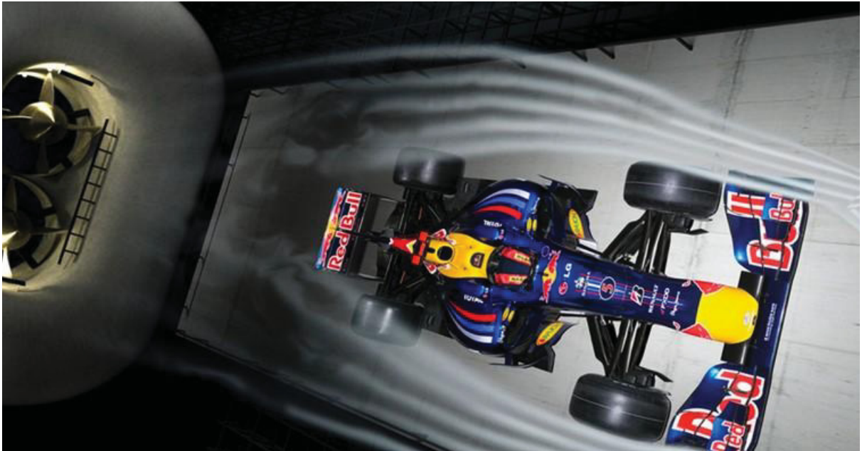
FIGURA 3 – CARRO DE F1 DENTRO DO TÚNEL DE VENTO
