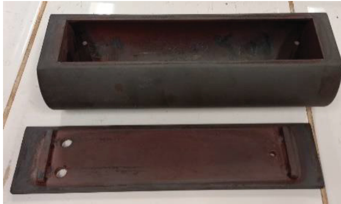
FIGURA 6 - REATOR UTILIZADO NA CARBONIZAÇÃO E NA ATIVAÇÃO
