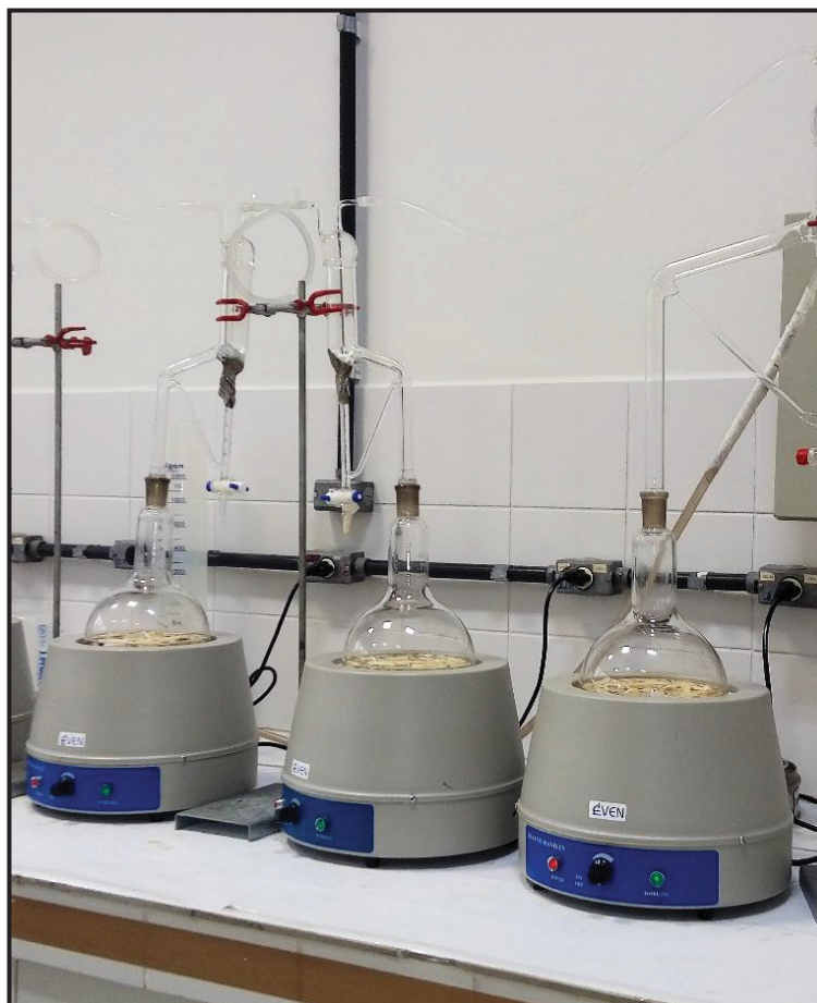
FIGURA 23 - PROCEDIMENTO DE HIDRODESTILAÇÃO UTILIZADO PARA AS AMOSTRAS DO LENHO E CASCA de Endlicheria paniculata
