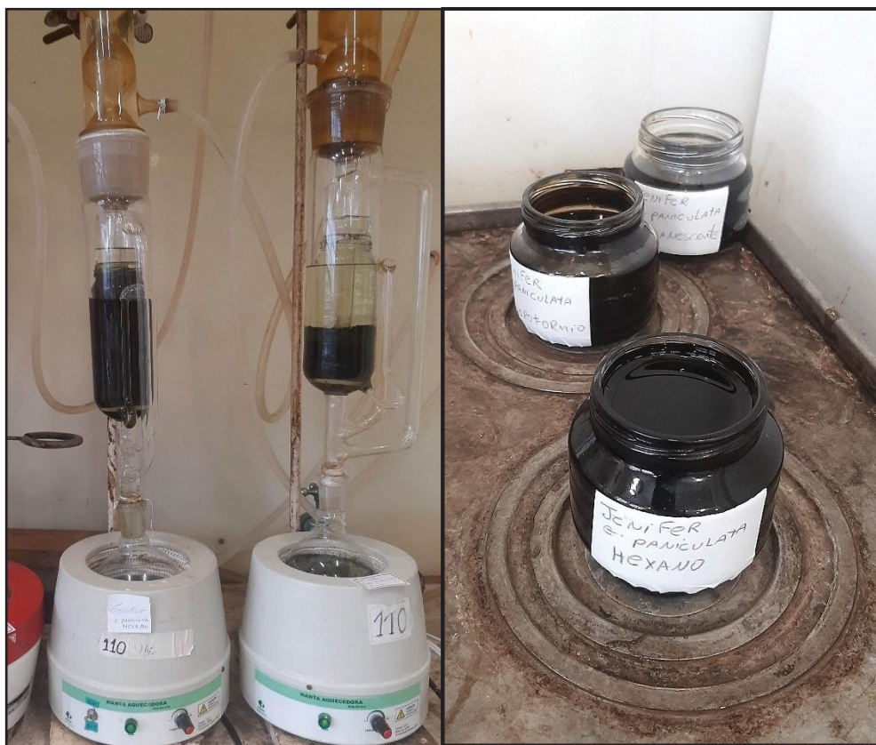
FIGURA 19 - PROCESSO DE FRACIONAMENTO DO EXTRATO BRUTO DE FOLHAS DE Endlicheria paniculata EM SOXHLET MODIFICADO E SECAGEM DO MATERIAL OBTIDO
