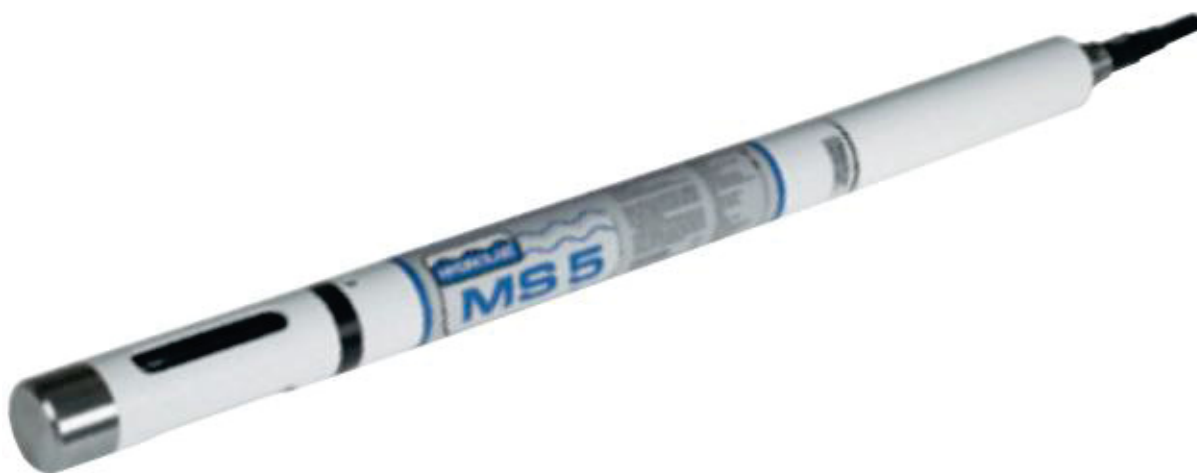
Figura 13 – Sonda HydroLab MS5 utilizada para medição de TDG em campo.
