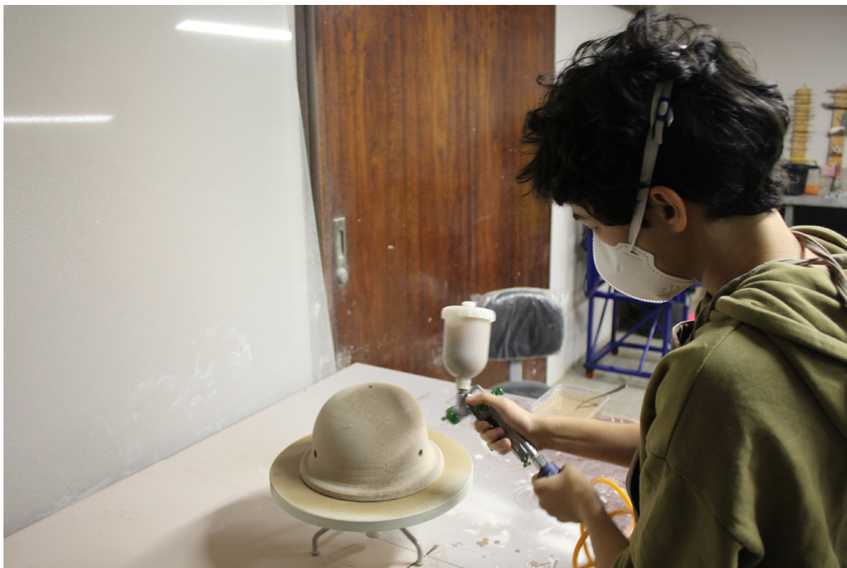
Figura 31 - Esmaltação com compressor de ar
