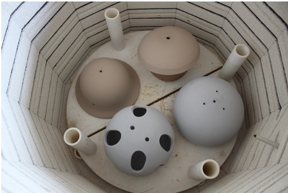
Figura 32 - Montagem da queima de alta temperatura
