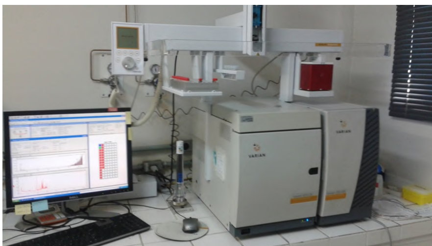
FIGURA 12. CROMATÓGRAFO ACOPLADO À UM ESPECTRÔMETRO DE MASSA UTILIZADO NA ANÁLISE DAS AMOSTRAS DO PRESENTE TRABALHO.
