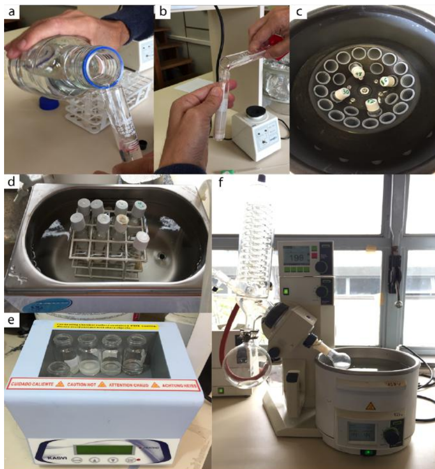
FIGURA 5. PROCEDIMENTO DE PREPARAÇÃO. (A) SOLVENTE DE DICLOROMETANO:METANOL, (B) ADIÇÃO DO SOLVENTE NA AMOSTRA, (C) CENTRÍFUGA, (D) ULTRASSOM, (E) DRYBLOCK E (F) ROTAVAPOR ROTATÓRIO.
