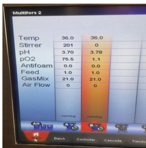
FIGURA 28 - PARÂMETROS FÍSICO-QUÍMICOS UTILIZADOS NOS REATORES 1 E 2
