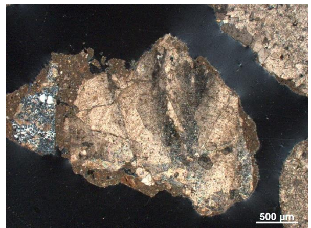
Shrub recrystalizado com linhas de crescimento verticais e extinção divergente, na borda observa-se micrita englobando fragmento substituído por sílica microcristalina à esquerda.
