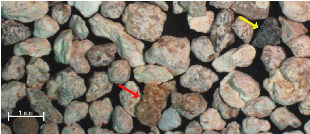
Figura 8 - Fragmentos de calha da amostra 138/19-227. A seta amarela indica fragmento de coloração cinza escura semelhante à fragmentos de origem ígnea; seta vermelha indica um fragmento de sal de coloração rosada.
