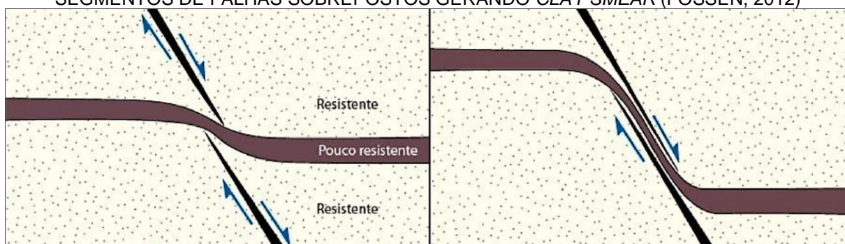
FIGURA 5.4 ARRASTO NORMAL EM CAMADAS MENOS COMPETENTES ENTRE DOIS SEGMENTOS DE FALHAS SOBREPOSTOS GERANDO CLAY SMEAR (FOSSEN, 2012)
