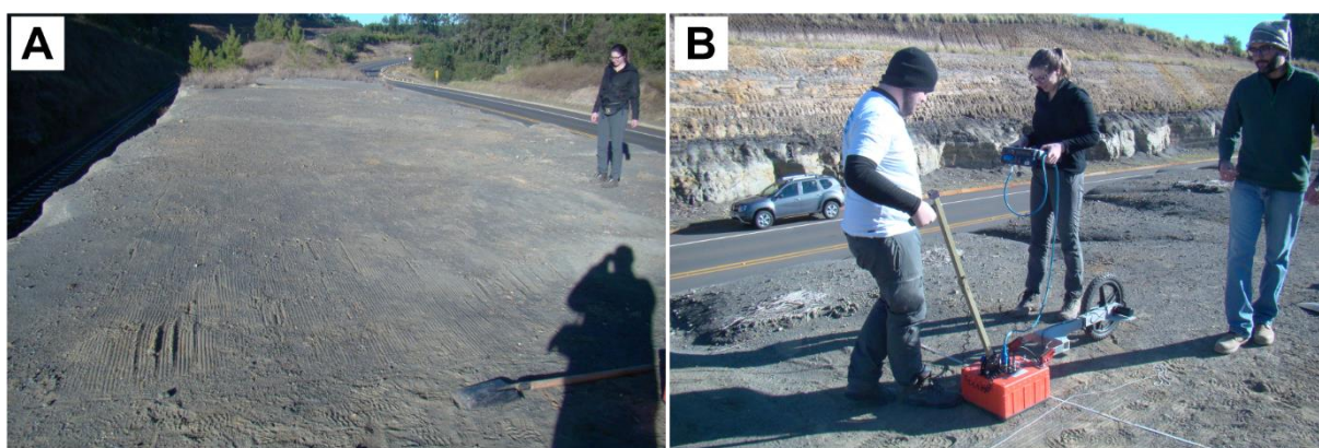
Figura 8: Coleta de dados de GPR ( Ground Penetrating Radar ) com ASIR3000 GPR System (GSSI) com antena de 400 mhz. Fonte: Thammy Mottin, 2021.
