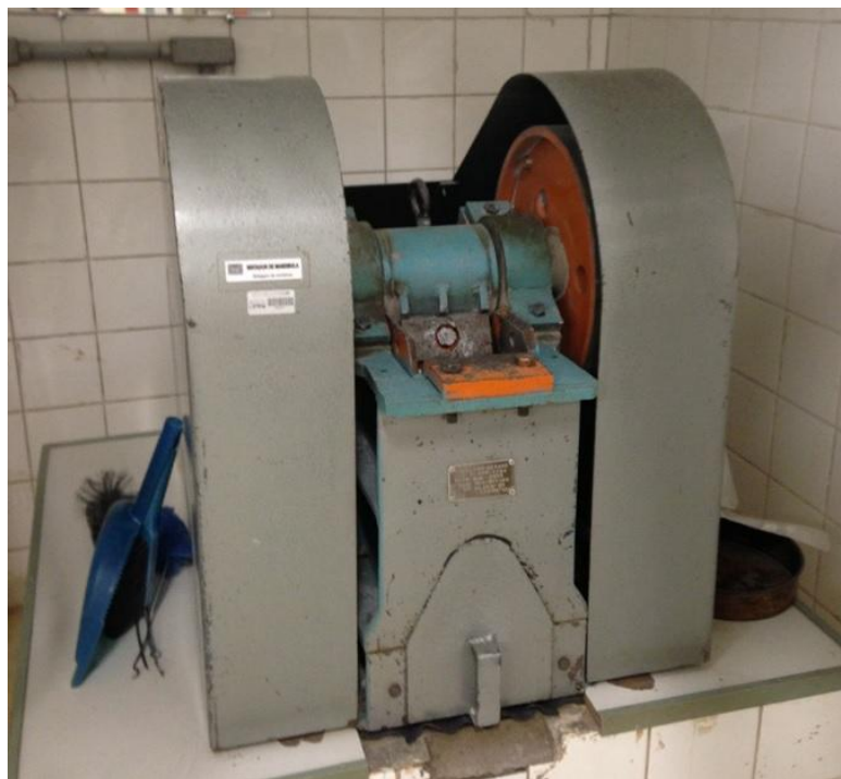
Figura 7 - Britador de mandíbula. (Fonte: www.lamir.ufpr.br . Acesso em 05/11/2016)
