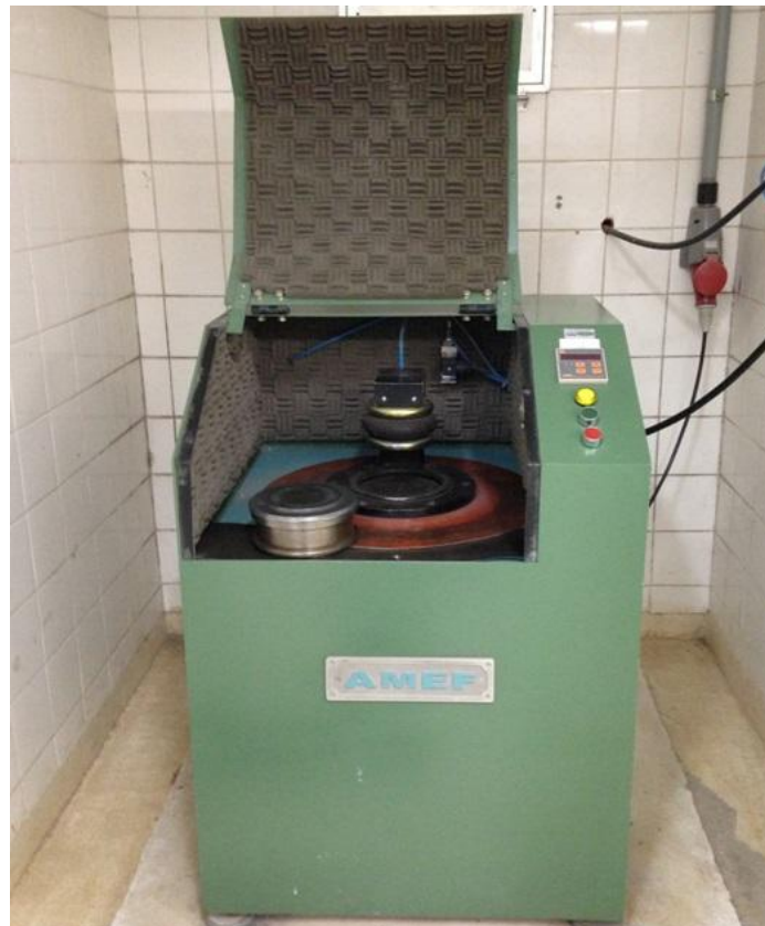
Figura 9 - Moinho de disco. (fonte: www.lamir.ufpr.br . Acesso em 05/11/2016)
