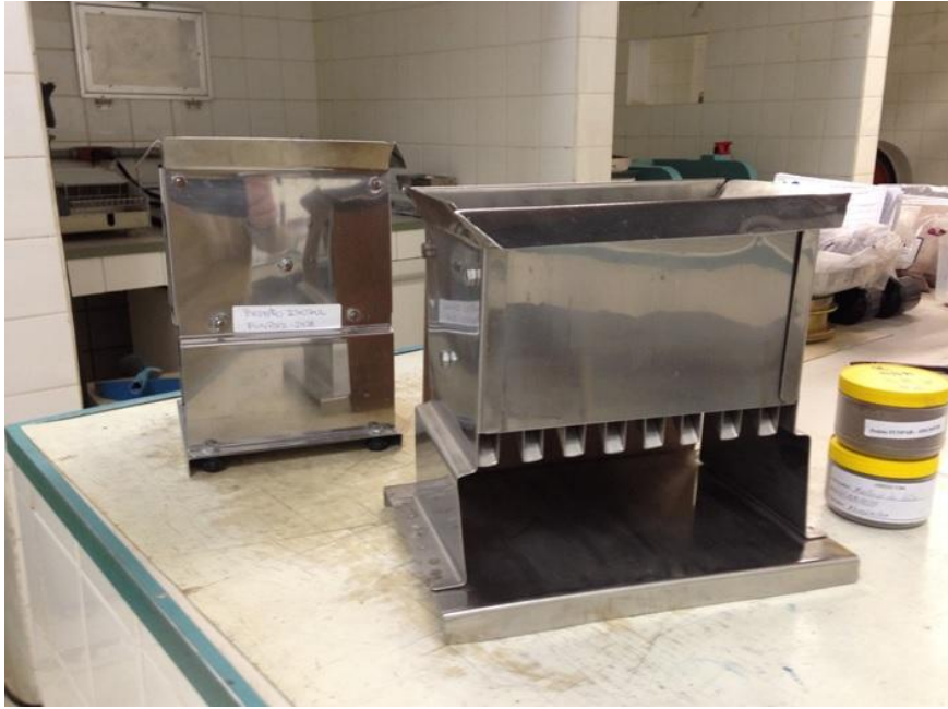
Figura 8 - Quarteador (fonte: www.lamir.ufpr.br . Acesso em 05/11/2016)
