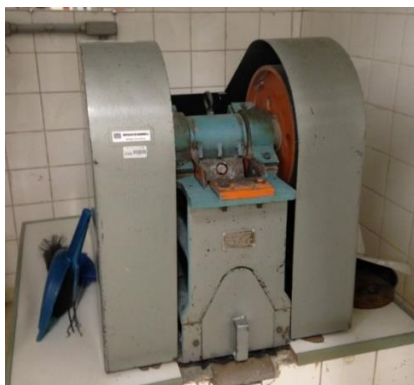
Figura 2.4.1: Britador de mandíbulas. Fonte: www.lamir.ufpr.br . Acesso em 02/10/2018.
