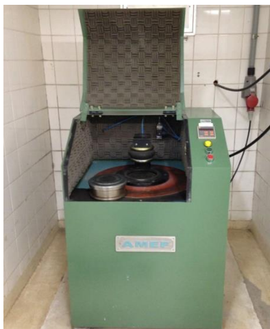
Figura 2.4.2: Moinho de discos da marca AMEF. Fonte: www.lamir.ufpr.br . Acesso em 02/10/2018.
