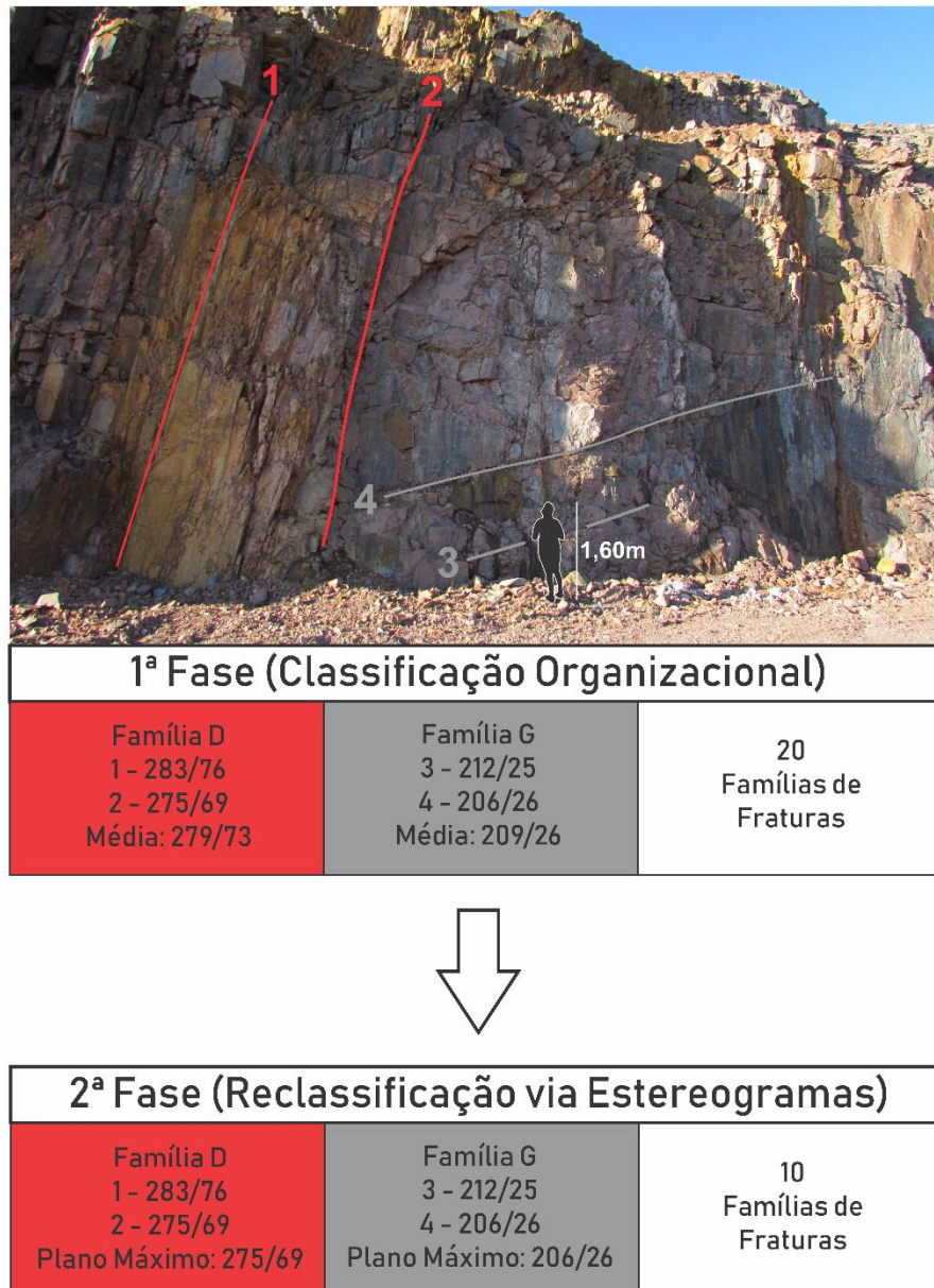
Figura 4.2: Fluxograma referente às fases de classificação adotadas para a separação de famílias de fraturas a partir das medidas de campo. Exemplificação referente a duas famílias visualizadas na zona 26, localizada na 4ª bancada.
