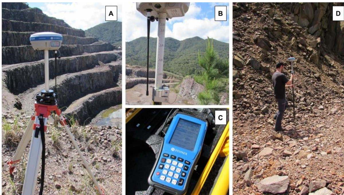
Figura 3.4: Composição do GPS RTK Stonex S8 Plus e sua utilização. A) Base do RTK instalada, medida e nivelada em relação ao terreno. B) Rover do RTK, acoplado a um bastão com nível. C) Estação coletora. D) Caminhamento na base de um talude.
