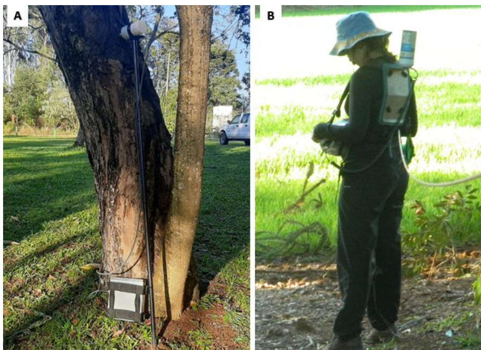
Figura 4. A) Magnetômetro GSM-19T; B) Magnetômetro MAG ENVI-VLF. Fonte: o autor.
