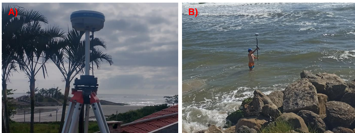
Figura 5: A) Base fixa do GNSS RTK. B) Rover do GNSS RTK durante caminhada.
