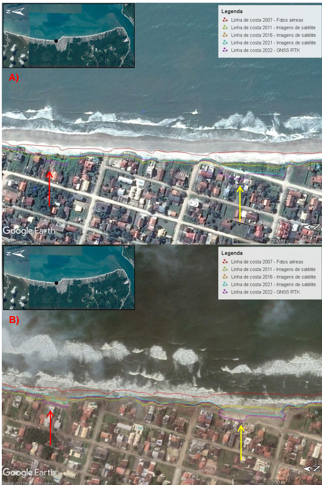
Figura 14: Variações da linha de costa próxima a 3ª Pedra. Seta em vermelho aponta para recuo da linha de costa em propriedades particulares e a seta amarela aponta para recuo da linha costa em via pública. A) imagem de 2009. B) Imagem de 2022, fonte: Google Earth Pro, 2023).
