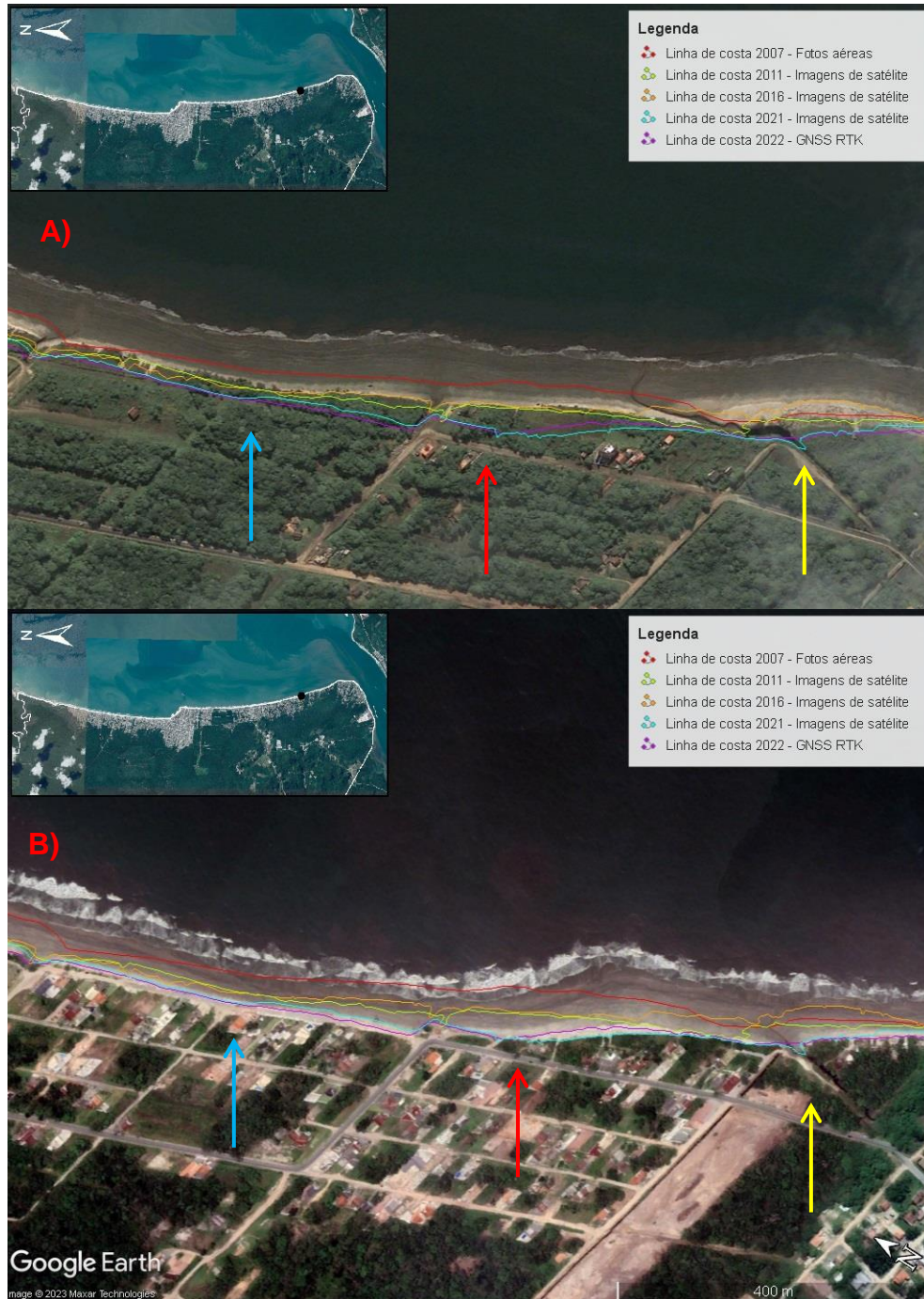
Figura 16: Variações da linha de costa. Setas em vermelho indicam o recuo da linha costa em relação à restinga, setas amarelas indicam via pública danificada pelo recuo da linha de costa e setas azuis apontam para região que sofreu enrocamento entre os registros. A) imagem de 2009. B) Imagem de 2022, fonte: Google Earth Pro, 2023).
