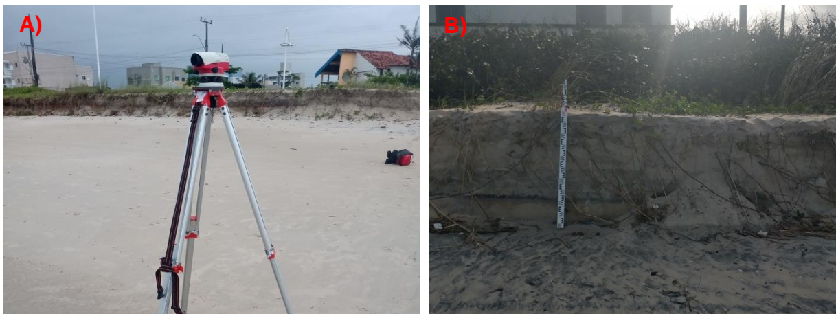
Figura 4: A) Mira graduada e nível de precisão. B) Régua.
